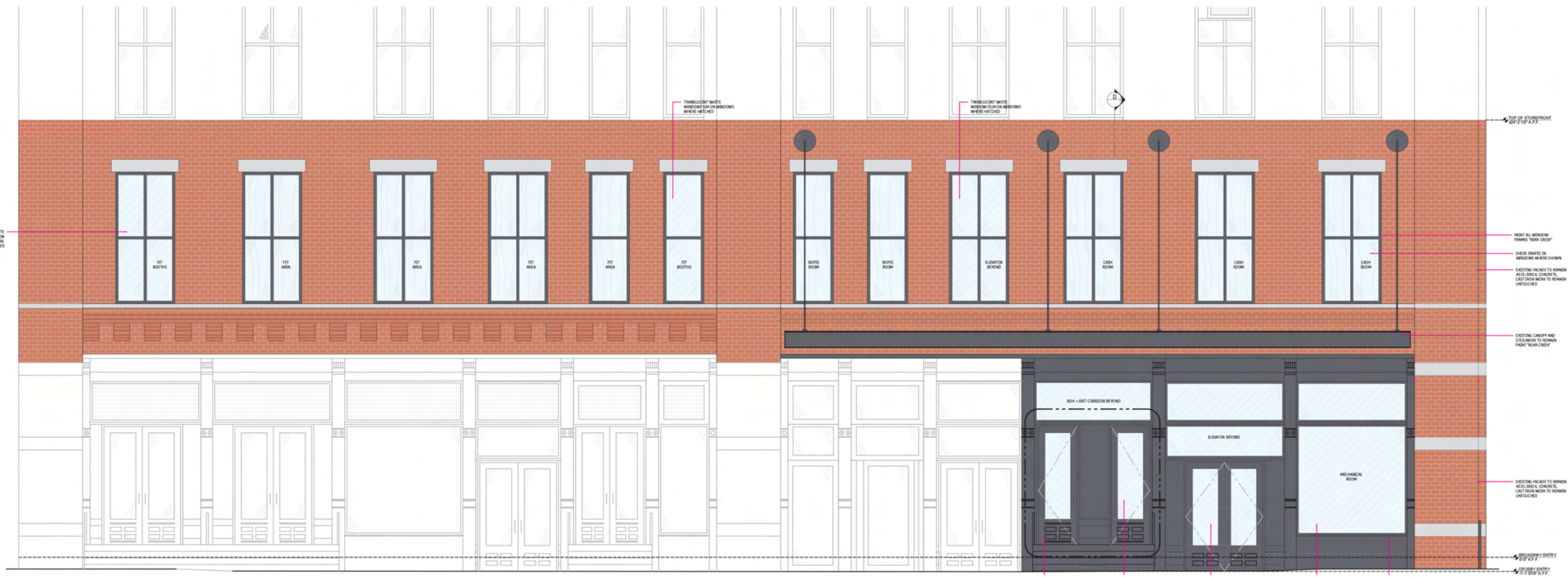
2 ELEVATION - STOREFRONT (CROSBY STREET SIDE) Scale: 3/8" = 1'-0"
