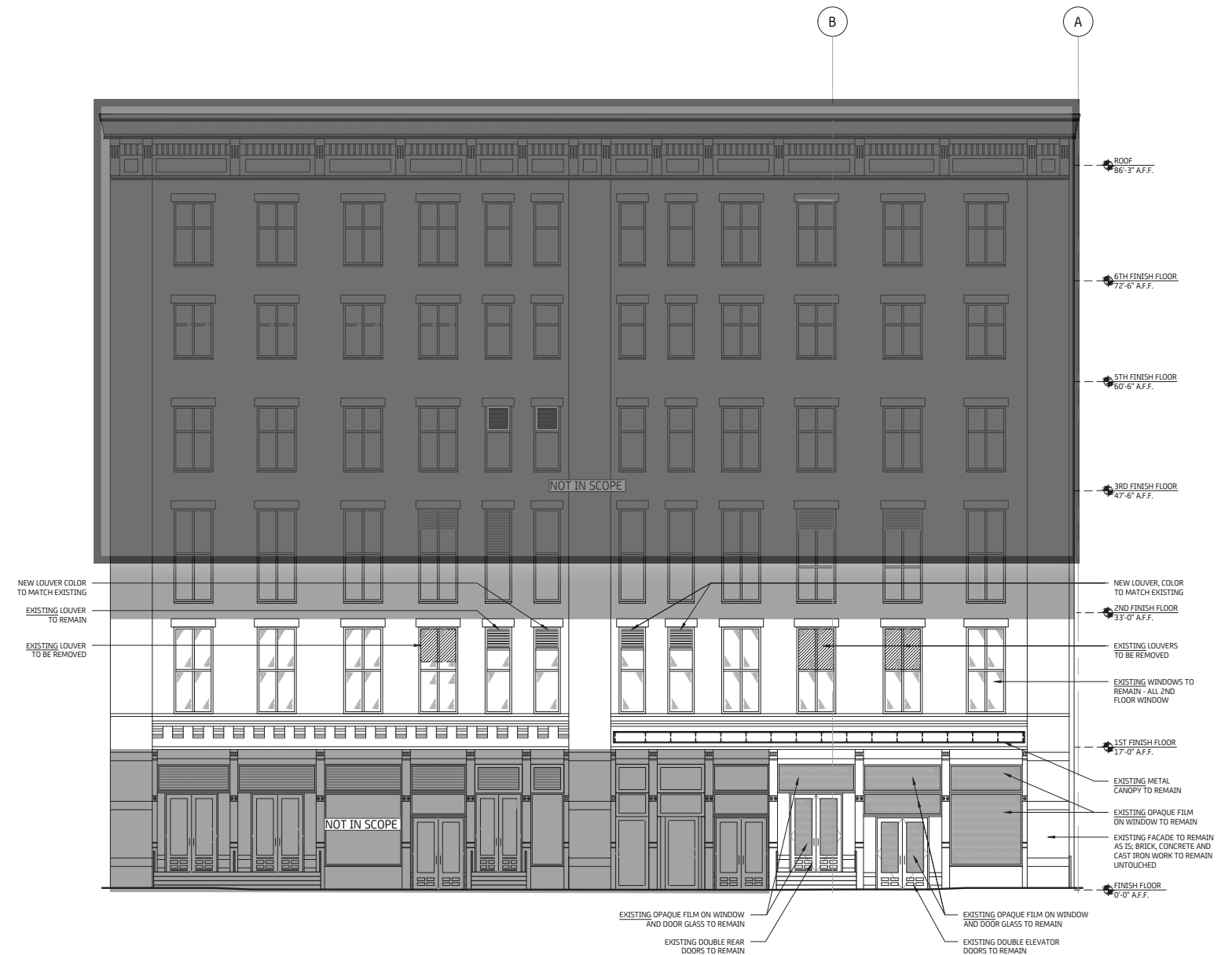
2 ELEVATION - STOREFRONT (CROSBY STREET SIDE) Scale: 1/8" = 1'-0"
